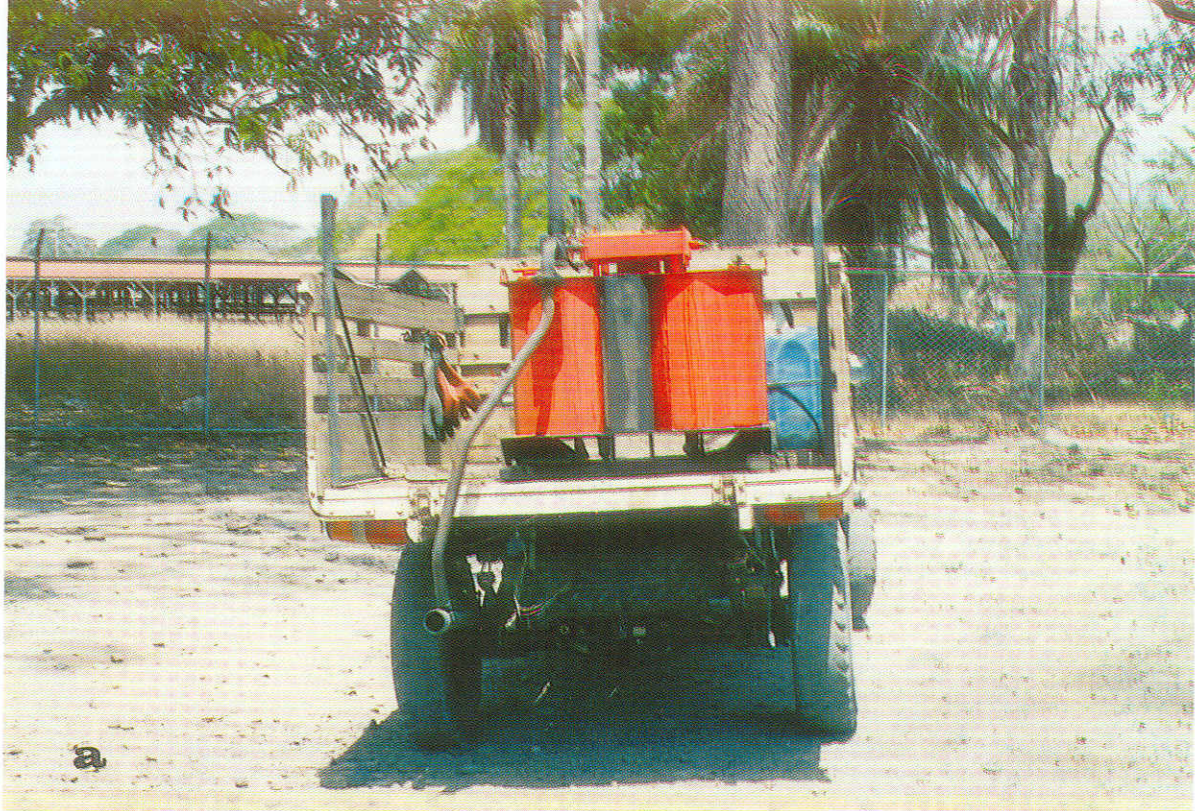
Fotog. 8 Exhaust Nozzle Sprayer adaptada a vehículo (a) y Aspersora Micronair AU-7000 (b) montada en tractor para controlar langosta.
