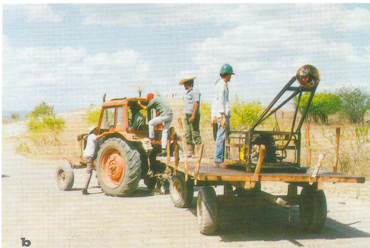
Fotog. 8 Exhaust Nozzle Sprayer adaptada a vehículo (a) y Aspersora Micronair AU-7000 (b) montada en tractor para controlar langosta.
